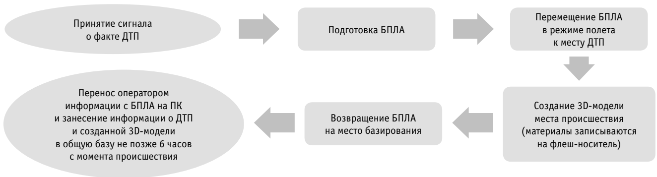
Рис. 2. Алгоритм работы БПЛА при фиксации дорожно-транспортного происшествия
