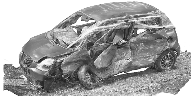
Рис. 1. 3D-модель деформированного автомобиля, созданная с использованием технологии Lidar
